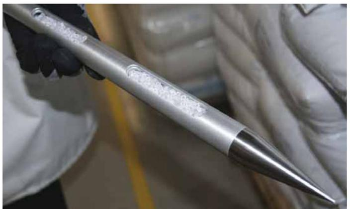
Zur Probennahme von Schüttgütern aller Art. Mit offenen Kammern für die Querschnittprobe durch alle Schichten des Probengutes. Entleerung über das offene Ende des Sammlers. Rohr-Ø 25 mm.
