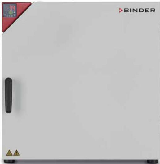
Für die Trocknung und Warmlagerung in Forschung und Qualitätssicherung. Mit Rampenfunktion, optischem Temperaturalarm und zeitverzögertem Ausschalten.
