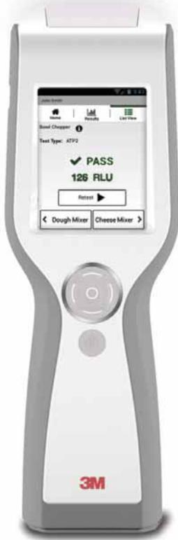
Einfaches, schnelles und zuverlässiges, Diagnosegerät zur Überprüfung der Reinigungseffektivität und Erfassung, Speicherung und Verwaltung von Daten für spätere Analysen.
