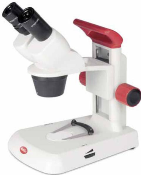
Mit netzunabhängiger LED-Beleuchtung. Die modernen Festarmstative mit integriertem Tragegriff sorgen für stabilen Stand und problemloses transportieren.
