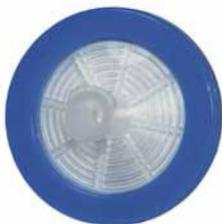
Hydrophile Membran für wässrige polare und leicht unpolare Lösungen. Sehr geringe Proteinbindungskapazität, für hohe Durchflussraten geeignet. Ideal für biologische Makromoleküle, wasserlösliche Oligomere und Polymere. Mit weiblichem Luer-Lock-Eingang und männlichem Luer-Slip-Ausgang. Sterile Produkte einzeln verpackt in einer Hartblisterverpackung und Spenderbox.
