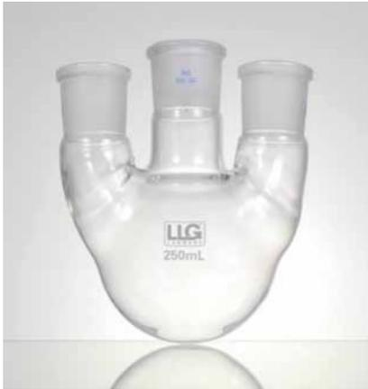
Seitenhalse sind parallel zum Mittelhals. Mit weißer Beschriftung. Nach DIN 12394, \*DIN 12392.
