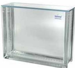
Für alle DC-Platten bis 200 x 200 mm. Flacher Boden mit Glassteg. Filterpapier für Gasraumsättigung, zur Verbesserung der Trennergebnisse.
