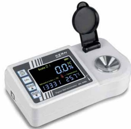
Präzises und wartungsfreies digitales Tischrefraktometer mit 2 Skalen, für universelle Anwendungen im Labor.
