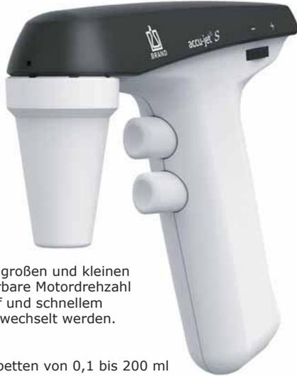
Für präzises Pipettieren von großen und kleinen Volumina. Durch die regulierbare Motordrehzahl kann zwischen freiem Ablauf und schnellem Ausblasen der Flüssigkeit gewechselt werden.
