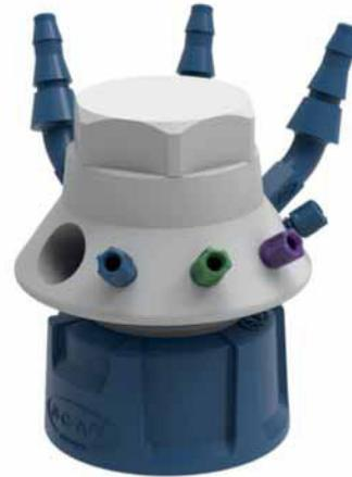
Safety Waste Cap zum Anschluss von 4 Kapillaren (UNF 1/4" 28 G), 3 Schlauch-Oliven (NPT 1/8") und einen Abluftfilter (GL 14). Mit frei drehbarer Kappe für einen einfachen Wechsel des Behälters.
