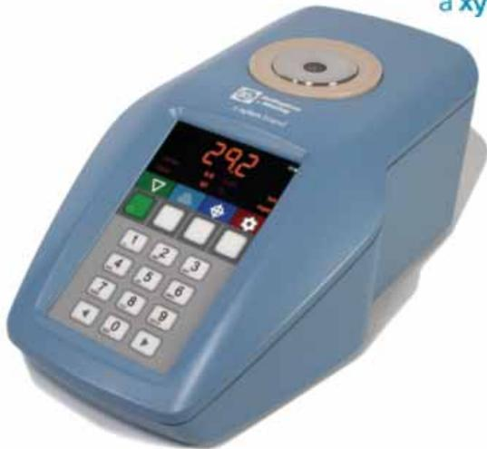
Robustes, voll automatisiertes Messgerät mit °Brix-Skala und automatischem Temperatenausgleich auf 20 °C gemäß ICUMSA für anspruchsvolle Anwendungen in der Lebensmittel-, Zucker- und Getränkeindustrie. Das Refraktometer kann mit einem Drucker oder Labor-PC verbunden werden und Messergebnisse in Standard-Druck-, CSV- oder sicheren PDF-Formaten ausgeben.
