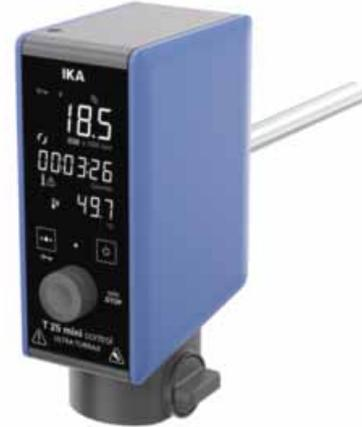
Hochleistungsdispergierer mit Temperaturmessung bis 125 °C für das Arbeiten mit kleinen Rotordurchmessern und hohen Umfangsgeschwindigkeiten. Kompakte Bauweise für den Einsatz auf engstem Raum, z.B. in Abzügen, wobei das große TFT-Display ein Ablesen aus größerer Entfernung ermöglicht. Für einfache Anwendungen zur Homogenisierung von Proben mit niedriger Viskosität.
