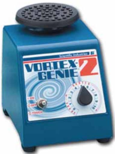
Robuste und zuverlässige Schüttelgeräte zum schnellen Mischen und Schütteln von Proben. Intervallbetrieb (mit Hilfe der Startautomatik ausgelöst durch Druck auf den Aufsatz) oder Dauerbetrieb möglich.
