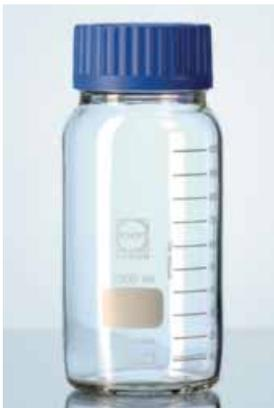
Laborflasche mit Weithals-Schnellgewinde (GLS 80®, AD 80 mm), Autoklavierbar und bis ca. 500 °C Temperaturbeständig. Neutralglas/Glasart I nach USP/EP. Mit Retrace Code (Chargenennung), Zertifikat via Internet. Mit Schraubverschluss und Ausgießring aus PP (Autoklavierbar und Temperaturbeständig bis 140 °C).
