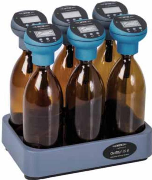
Einfach bedienbares, respirometrisches Messsystem zur Bestimmung des biologischen Sauerstoffbedarfs (BSB). Der BSB kann gleichzeitig in bis zu 6 bzw. 12 Proben bestimmt werden.
