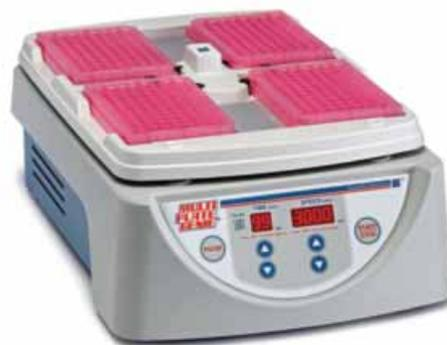
Schüttler für ein kräftiges, gleichmäßiges Vortex-Mischen von bis zu 4 Mikrotiterplatten.
